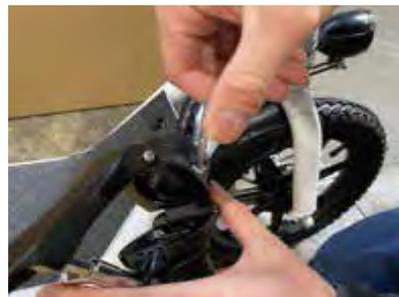
ハンドルポスト固定部のネジを外します。ハンドルポストのクイックレバーを解除しハンドルポストの横の六角レンチを2本緩めます。
