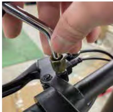
ミラー下部のナットを反時計回りに回して最後部までずらしします。
