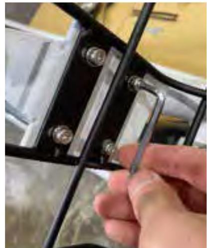
車両後方のかご取付位置のネジとワッシャーを4箇所外します。
