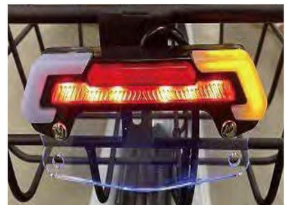
⑤ハンドル左側の方向指示器を左にスライドすると左のウィンカーが点灯し右にスライドすると右のウィンカーが点灯します。
