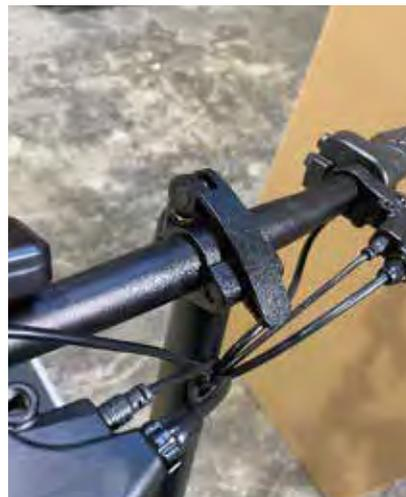
ハンドルバーの固定ノブを引き上げてハンドルバーの位置を調整します。この時にハンドルバーの長さが左右対称で地面に対して垂直になるように調整してください。位置が決まったら固定ノブを戻ししっかり固定してください。
