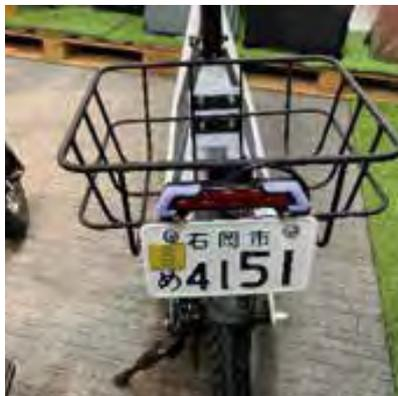
かごを取り付けたら次に方向指示器のケーブルを結束バンドを用いてかごと車体フレームに固定します。
