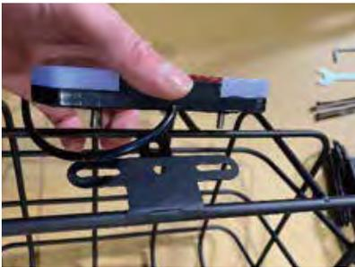
方向指示器の裏面のナットを外しかごの方向指示器取り付け位置に合わせます。
