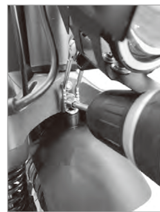
③ 本製品とヘッドライトを②で外したネジで固定します。
