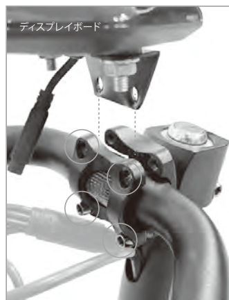
③ ディスプレイボードを図のように設置し、ネジ穴の位置を合わせてネジで締めます。
