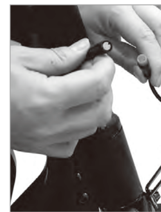
④ ヘッドランプのコードと電源コードを接続します。
