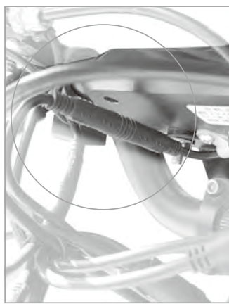
① ディスプレイボードワイヤーと電源コードを接続します。
