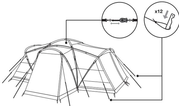
天頂部内側のガイラインをバックルで連結し、テンションをかけて調整してください。最後に外側のガイラインを張りペグで固定し、テンションを調整して全体のバランスを整えてください。
