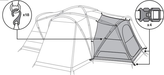
インナーテントを使用する際は、インナーテントとテント本体を四隅のバックルで固定します。テント本体のリングにインナーテントのフックを引っ掛け、四隅のアジャスターでテンションを調整します。※インナーテントは左右どちらにも設置することができます。別売りのインナーテントを追加することで両サイドへの取り付けも可能です。
