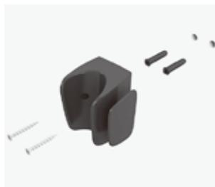
1. 壁掛け用器具を壁に取り付けるには、ドリルで壁に2つ穴を開け、2本のプラスチック製チューブを挿入して、2本のねじで器具を留めます。
