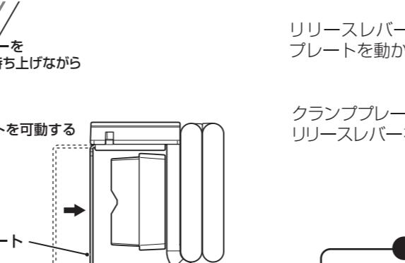
リリースレバーを持ち上げながらクランププレートを動かして位置を調整します。
