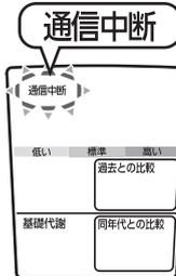
通信中に衣服(スカートなど)でさえぎると通信中断が表示されます。また、測定中に受信できない状態が続くと、左図のように「通信中断」のマークが操作部(表示部)に点滅します。
