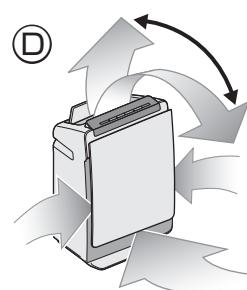
● 風量「ター」運転時は、フロントパネルを開いた状態で運転します。
