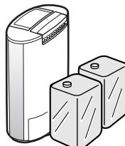
空気中に揮発した薬品や溶剤により除湿乾燥機が劣化し、除湿した水が漏れて家財などをぬらす原因になります。
