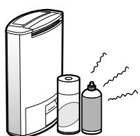
油・可燃性ガスに引火したり、本体に吸引されて発火、発煙の原因になります。
