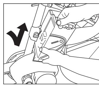
両手で支えながら引き上げて外す。バッテリーロックキーを時計方向に60度戻しキーを抜く。
