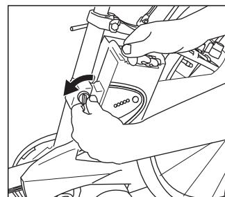
バッテリーを支え、バッテリーロックキーを反時計方向に60度回す。
