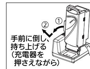
残量表示ランプが消灯(充電完了)していることを確認し、充電器を押さえながらバッテリーを外した後、コンセント(AC100 V)から電源プラグを抜く。
