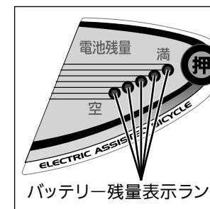
バッテリーの残量表示ランプの点灯(赤色)を確認する。
