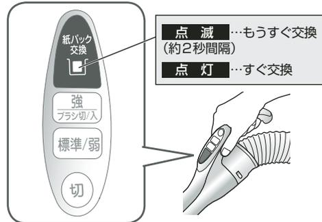
■早い点滅…「切」を押し、電源プラグを抜いてください。(P.13) (Fast flashing... press 'Off' and unplug the power cord.)
