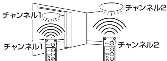
① **チャンネル設定スイッチ** リモコン受信器の「チャンネル設定スイッチ」を押す
