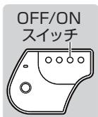
リモコン受信器の「OFF/ONスイッチ」を「ピッ」と音がするまで押し続ける
