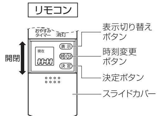
時刻表示：現在時刻を設定後 (表示) を押すたびに、上図のように表示が切り替わります。
