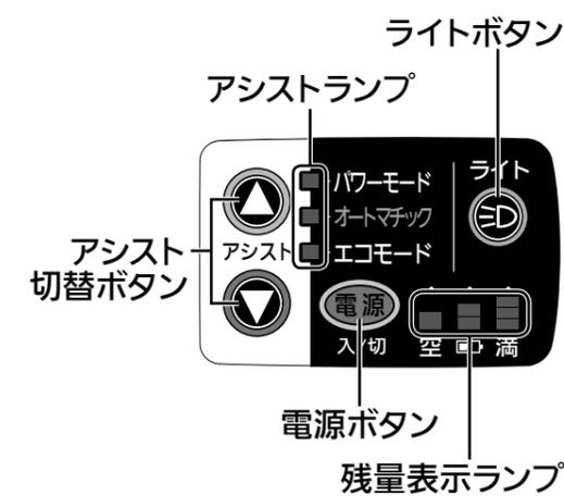
※電源ボタン「入」のとき、バックライトが点灯し、夜間走行時もボタン操作がしやすくなっています。
