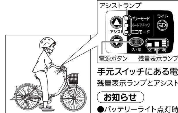
手元スイッチにある電源ボタンを押して、電源を切る。
