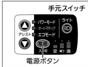
手元スイッチの電源ボタンを押して電源を切る。(全ランプ消灯)
