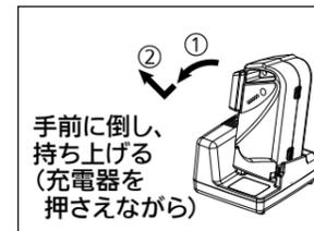
残量表示ランプが消灯(充電完了)していることを確認し、充電器を押さえながらバッテリーを外した後、コンセント(AC100 V)から電源プラグを抜く。
