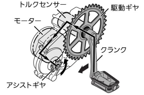
ペダルの踏力を、クランクを通じてトルクセンサーで感知し、最適なアシスト力をモーターからアシストギヤへ伝えることにより、快適なアシスト走行を実現しています。
