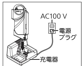
電源プラグをコンセント(AC100 V)に差込み、バッテリーを充電器に奥まで押し込む。
