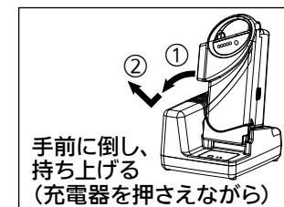
充電ランプの消灯(充電完了)を確認してから、充電器を押さえながらバッテリーを外した後、コンセント(AC100 V)から電源プラグを抜く。
