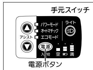
手元スイッチの電源ボタンを押して電源を切る。(全ランプ消灯)
