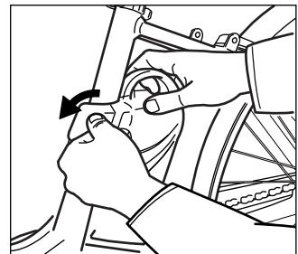
バッテリーを支え、バッテリーロックキーを反時計方向に45度回す。
