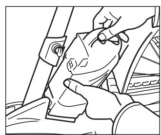
両手で支えながら引き上げて外す。バッテリーロックキーを時計方向に45度戻しキーを抜く。
