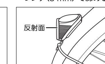
⑤後ろよけにソーラーオートテールを取り付け、裏側のナットをレンチ(8 mm)で締める(反射面後向き)
