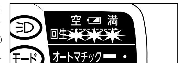
残量表示ランプが回生電中に点滅
