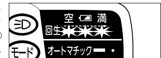
残量表示ランプが回生電中に点滅
