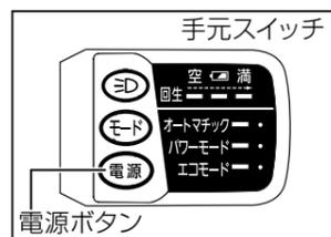
手元スイッチの電源ボタンを押して電源を切る。
