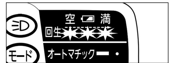
残量表示ランプが回生充電中に点滅（ハーフ回生充電時より、フル回生充電時の方が点滅スピードが速くなります）
