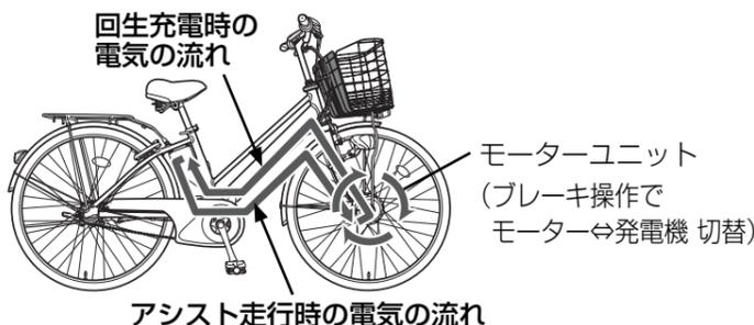
ペダルの踏力を、クランクを通じてトルクセンサーで感知し、最適なアシスト力をモーターユニットに発生させることで、快適なアシスト走行を実現しています。
