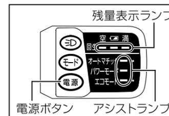
手元スイッチにある電源ボタンを押して、電源を切る。
