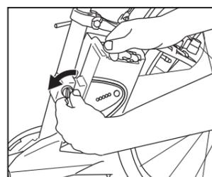
バッテリーを支え、バッテリーロックキーを反時計方向に 45 度回す。
