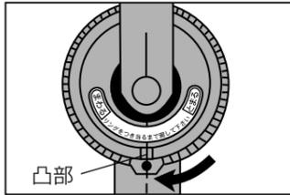
リングの赤い●印を時計方向（**まわる**側）に回し、凸部と合っていることを確認してください。
