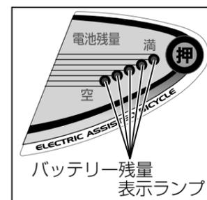
バッテリーの残量表示ランプの点灯 (赤色) を確認する。
