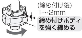
(締め付け後) 1~2mm 締め付けボディを強く締める
