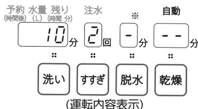
※「洗濯～乾燥」自動運転のときは、効率よく乾燥するため脱水時間が長くなります。(「-」表示) [158ページ](#)
