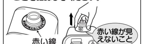
○必ず火の気のないところで口金を下にして油漏れがないことを確認してください。
