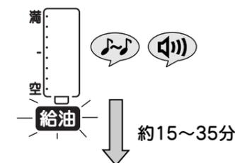
○カートリッジタンクの灯油がなくなると、音声メッセージのお知らせと同時に給油サインがゆっくりと点滅します。(バックライトの色は「ピンク」の点灯になります)
