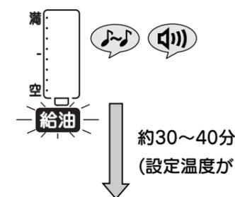
○油受皿の灯油が残り少なくなると、音声メッセージのお知らせと同時に給油サインが速く点滅し、火力が小さくなります。設定温度が「Hi」のときは、大火力で燃焼します。
