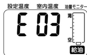
○そのまま使用を続けると、油受皿の灯油がなくなり、音声メッセージでお知らせし、「E 03」を表示して自動消火します。(バックライトの色は「赤」の点滅になります) 使用状況により2回目のお知らせと同時に消火することがあります。
