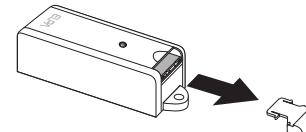
②リチウム電池の極性を確認して電池ケースにセットします。
