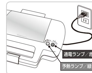
⚠️ 本製品にはスイッチが付いていません。電源プラグをコンセントに差し込むと通電し、本体が熱せられます。使用後は必ず電源プラグを抜いてください。
