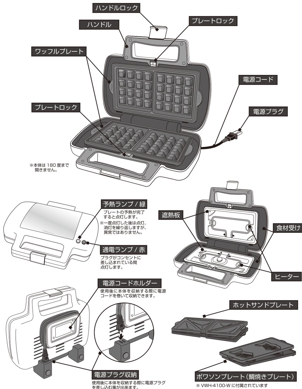
⚠ 電源コードホルダーに電源コードを巻き付けたまま使用すると、電源コードが加熱して、故障や発火、火災の原因になりますのでおやめください。
