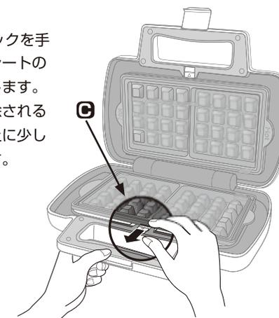
2 ロックが解除されたプレートを両手でしっかりと持ち静かに手前へ取り外します。
