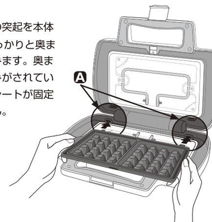
2 プレートの溝をプレートロックで固定するためにBの箇所をカチッと音がする所までプレートを上から押します。
