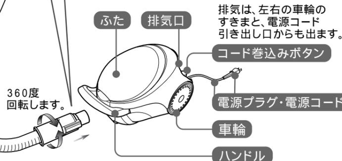
排気は、左右の車輪のすきまと、電源コード引き出し口からも出ます。
