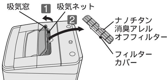
**2** ナノチタン消臭アレロフフィルターが汚れたときは、フィルターカバー側から、掃除機で吸い取る
