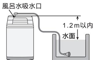
風呂水吸水口から浴槽水面までの高さは、1.2m以内にしてください。水位が低いと風呂水吸水できない場合があります。
