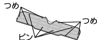
**お願い** ナノチタン消臭アレロフフィルターは、フィルターカバーのつめ(6箇所)、ピン(4箇所)にはさみ込むように取り付けてください。
