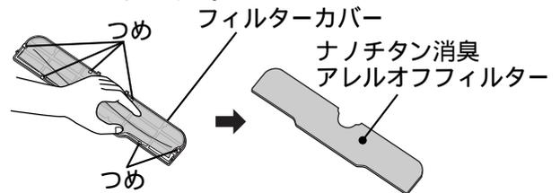
**4** フィルターカバーにナノチタン消臭アレロフフィルターをセットする
