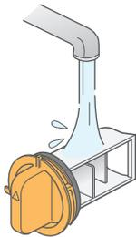
**4** 異物トラップのトラップ部を、下図の矢印方向にカチッと音がるまで確実に回す
