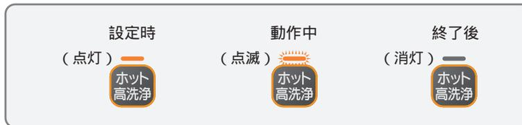
ランプは、温風が出ている約10分間点滅し、その後消灯します。
