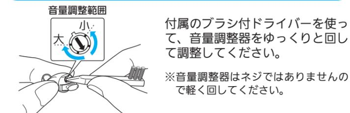
付属のブラシ付ドライバーを使って、音量調整器をゆっくりと回して調整してください。
