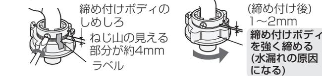
取り付け直すときは、締め付けボディをゆるめ、ねじ山が4mm程度見える状態でおこなってください。
