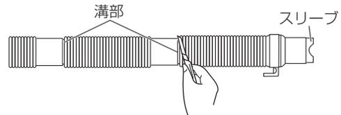
(本体と洗濯パンなどの排水口の距離に応じて溝部) 2カ所のうち、どちらかの溝部を切ってください。
