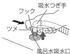
**7** 風呂水吸水口の中から、ポンプフィルターを取り出し、ゴミを洗い流す
