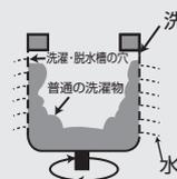
洗濯物の水は洗濯・脱水槽の穴から抜け出る
