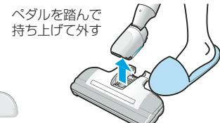
・取り付けは、先端を差し込んで、「カチッ」と音がするまで下に確実に押し込む
