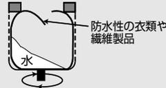
洗濯・脱水槽が回転しても水が防水性の衣類や繊維製品から出られないため、水が片寄って大振動を引き起こす
