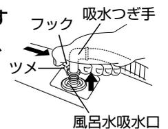
6 風呂水吸水口の中から、ポンプフィルターを取り出し、ゴミを洗い流す
