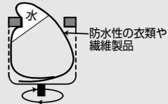
洗濯・脱水槽が高速回転しても水が防水性の衣類や繊維製品から出られないため、水が上に移動して大きな振動とともに飛び出る
