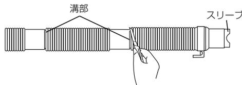
(本体と洗濯パンなどの排水口の距離に応じて溝部) (2カ所のうち、どちらかの溝部を切ってください。)
