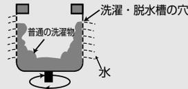
洗濯物の水は洗濯・脱水槽の穴から抜ける
