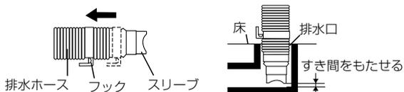
排水ホースは、排水時の水の力や振動などで動く場合がありますので、排水口にしっかり差し込み抜け出さないように固定してください。
