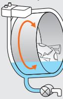
ドラムを回転させて、洗剤を溶かします。
