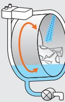
ドラムの手前から水を間欠的に出しながらドラムを回転させます。
