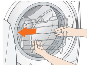
3 乾燥棚の手前側を、衣類投入口カバーの左右にある突起の内側に合わせる
