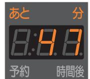
洗濯物の量に合わせて設定時間が変わる場合があります。約1分後に給水が始まります。コースボタン(点滅)を押すと、すぐに給水を開始します。
