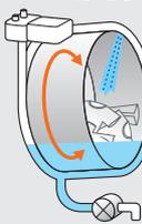
ドラムの手前から水を間欠的に出しながらドラムを回転させて、洗剤分をもみ出します。
