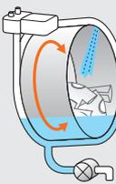
ドラムを回転させながらドラムの手前から水を流し、ドラム内に水をためます。
