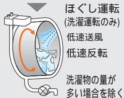
洗濯物に片寄りがある場合には、脱水運転中にほぐし動作を行うために給水、ドラム回転、排水動作を行う場合があります。脱水設定時間(例: 4分)は、ドラムが一定の回転速度で高速回転する時間であり、実際の運転時間には、ほぐし動作、ドラムの回転数を上げる動作の時間も含まれます。
