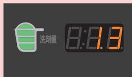
メロディが鳴って洗濯物の量を計測し、30秒～2分後に洗剤量(目安)を表示します。
