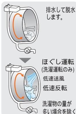
洗濯物に片寄りがある場合には、脱水運転中にほぐし動作を行うために給水、ドラム回転、排水動作を行う場合があります。脱水設定時間(例: 4分)は、ドラムが一定の回転速度で高速回転する時間であり、実際の運転時間には、ほぐし動作、ドラムの回転数を上げる動作の時間も含まれます。
