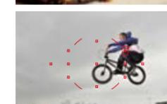
**オートエリアAFモード** カメラが自動的にすべてのフォーカスポイントから被写体を判別してピントを合わせます。合焦時には、合焦範囲内と判断したフォーカスポイントが複数点灯します。
