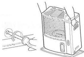
**6** 油受けざら内の灯油を抜き取る。油受けを取り出してから、油受けざら内の灯油を市販の給油ポンプ（手動式）で抜き取ってください。
