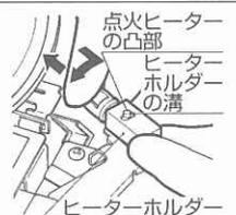
6 片手でヒーターホルダーをつまみ、新しい点火ヒーターの凸部をヒーターホルダーの溝を通すように入れたら、押しつけながら回して、点火ヒーターの凸部を、ヒーターホルダーの凹部にはめ込んでください。
