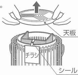
3 炎筒内部の包装材とシール、包装材にシールで貼り付けてあるチラシを取り出してください。包装材を取り出さずに使用されると、火災のおそれがあります。
