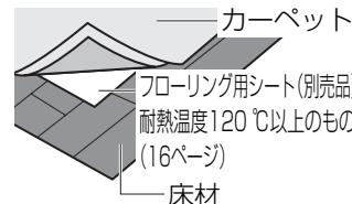
断熱をしないと、床材の変色・変形・割れ・すき間の原因になります。
