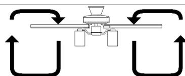
※ファンの風向は、リモコン送信機側面の「風向切替スイッチ」で設定してください。
