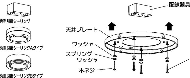
⚠ 警告 木ネジは必ず補強材のある箇所に確実にとめてください。
