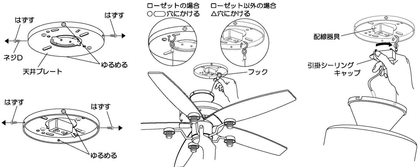
1. あらかじめ、天井プレートについてあるネジDの一对をはずし、もう一对のネジDをゆるめておきます。
