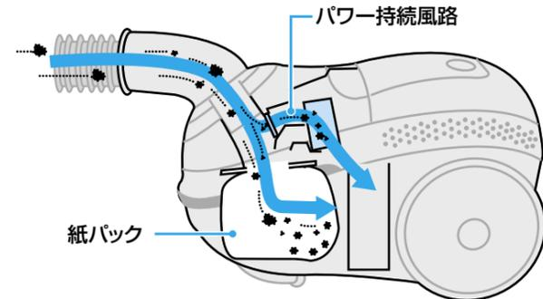
2つの風路でしっかりゴミを吸い込みます。紙パックが目詰まりしても、パワー持続風路でゴミを吸い込むので、吸引力が持続します。紙パックの中のゴミを圧縮するために、運転中に風路が切り換わることがあります。その際、運転音が変わりますが、異常ではありません。
