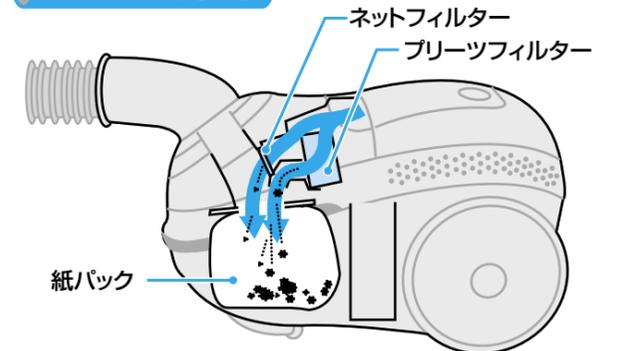
プレフィルターとネットフィルターに付着したゴミを自動ちり落とし機構とエアークリーン機構で紙パックへ運ぶのでパワー持続風路内のフィルターはきれいに保たれ、吸引力が持続します。
