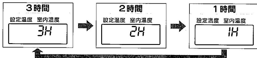
〔延長時間セレクトキーを押している間、デジタル表示部には延長時間が表示されますが、手を放すと自動的に温度表示に切りかわります。〕
