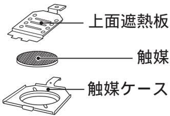
触媒防臭装置は、灯油が燃焼することにより発生する微量の一酸化炭素(CO)や、においのもととなる炭化水素(HC)を触媒作用でセーブするための燃焼ガス浄化装置です。
