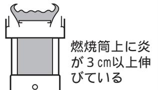
点火後15~20分たって、部分的な炎の伸びや、燃烧筒の赤熱ムラがでるときは、燃烧筒つまみを持って左右に軽く2~3回動かしてください。それでも炎が伸びてきたら、しん調節つまみを左(ニオイカット消火位置)方向へまわして正しい炎の状態に調節してご使用ください。
