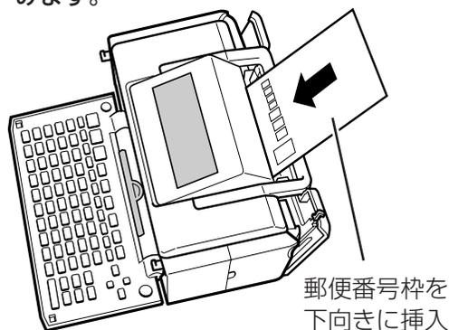
一度にセットできる枚数は、官製はがきの厚さの場合で「20枚まで」です（印刷枚数は99枚まで設定可能です）。ただし、「インクジェット写真用年賀葉書」を使用する際には、一度にセットする用紙は、必ず1枚だけにしてください。
