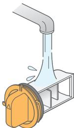
**4** 異物トラップのトラップ部を、下図の矢印方向にカチッと音がするまで確実に回す
