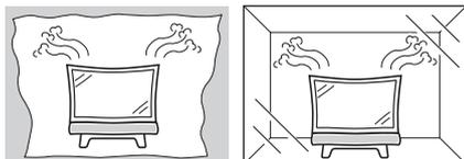
● 通風孔をふさぐと内部に熱がこもり、火災の原因となることがあります。壁に埋め込む設置や枠で囲むなどをしないでください。
