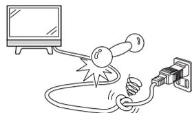
電源コードが傷んだら(芯線の露出、断線)交換をご依頼ください。そのまま使用すると、コードが破損して、火災・感電の原因となります。
