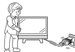
接続線を外さないで移動させると、電源コードが傷つき火災・感電の原因となることがあります。
