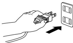
電源プラグはコンセントに根元まで確実に差し込んでください。差し込みが不完全ですと発熱したり、ホコリが付着して火災・感電の原因となることがあります。また、電源プラグの刃に触れると感電することがあります。
