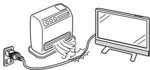
電源コードの被覆が溶けて火災・感電の原因となることがあります。
