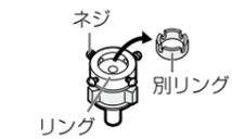
3 ホース継手の4本のネジをゆるめ、蛇口に押しあてます。
