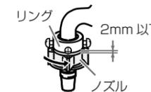
6 ノズルとリングのすき間が2mm以下になっているかを確認します。
