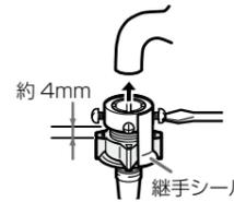
5 継手シールをはがし、ノズルを矢印方向へ回して、しっかり締め付けます。
