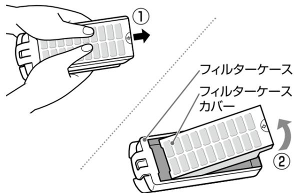
※フィルターケース内で糸くずが固まり、フィルターケースカバーがはずしにくい場合は、フィルターケースを濡らし、糸くずを柔らかくすると取りはずしやすくなります。
