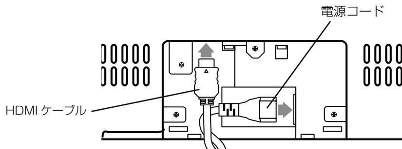
2 HDMI ケーブルと電源コードをクランプで固定する
