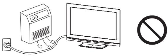
■ 移動させる場合は、電源スイッチを切り、必ず電源プラグをコンセントから抜く
