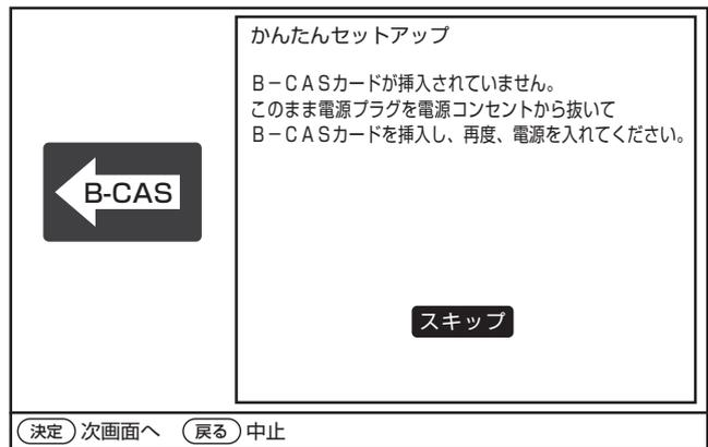
電源プラグを電源コンセントから抜いて、B-CAS カードを挿入して、再度電源を入れてください。
