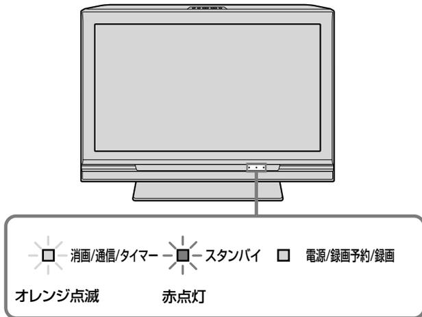
消画／通信／タイマーランプ点滅中は、本機内部の回路が自動的に動作し、データ受信とソフトウェアの書き換えをしています。
