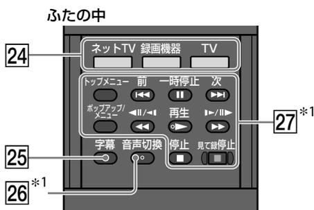
\*1 の付いたボタン(チャンネル+ボタン、音声切替ボタン、再生ボタン、数字ボタンの「5」)の上には、凸点(突起)が付いています。操作の目印として、お使いください。
