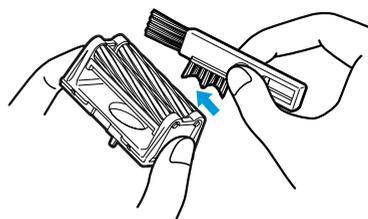
4 掃除した後は、キワゾリ刃を収納して、外刃を取り付ける。
