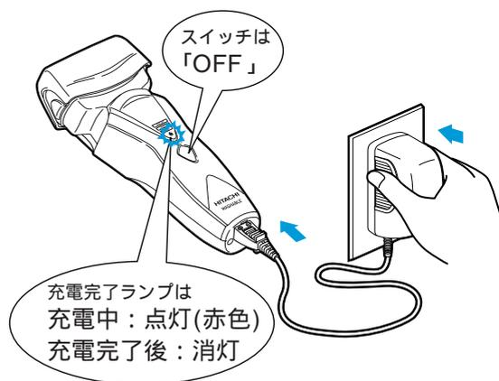
蓄電池が完全放電していますと充電完了ランプが点灯しない場合があります。そのまま充電を続けると充電完了ランプ点灯後に蓄電池への充電を開始します。
