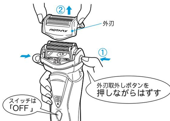
2 外刃取外しボタンの下を押さえ、新しい外刃を取り付ける。
