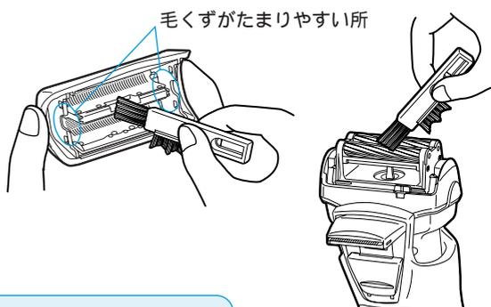
3 刃先にこびりついた毛くずは内刃をはずして掃除する。内刃は18ページの「内刃の取り替えかた」に従ってはずし、取り付けます。
