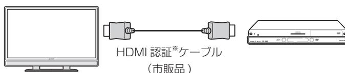
※ HDMI ケーブルは、必ず市販の HDMI 規格認証品をご使用ください。規格外のケーブルを使用した場合、映像が映らない、音が聞こえない、ファミリンクが動作しないなど、正常な動作ができません。
